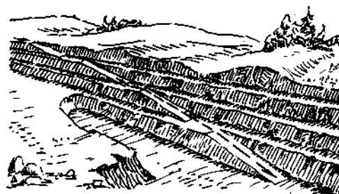
РИС. 4.1. Вид борта карьера при вскрытии системой внутренних поступательных траншей
