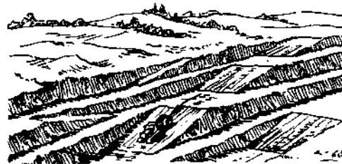
РИС. 16.4. Вид карьера при применении системы разработки продольными наклонными ходами с углубкой карьера
